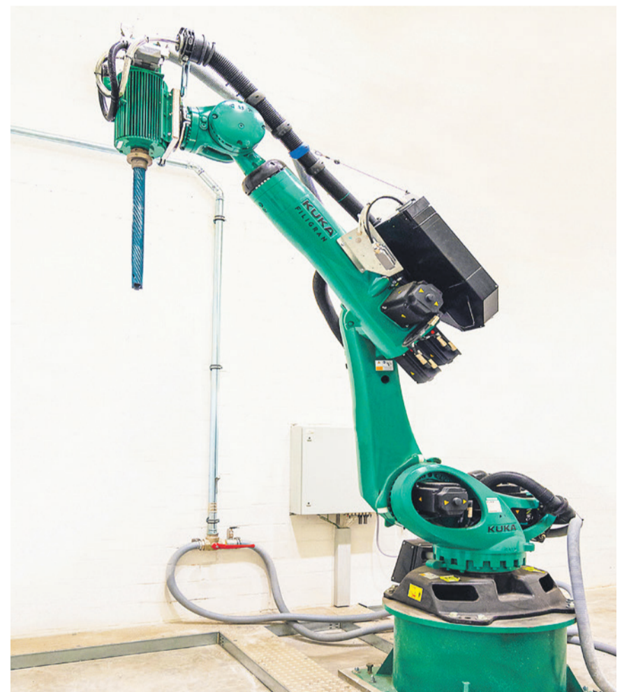
Automation beim Bauen: Der «Filigran»-Fräsroboter produziert Schalungen für Betonelemente gegenüber konventioneller Bauschreiner-Arbeit in einem Bruchteil der Zeit. Foto: zvg
